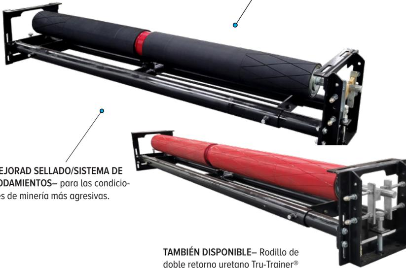
**MEJORAD SELLADO/SISTEMA DE RODAMIENTOS**— para las condiciones de minería más agresivas.
